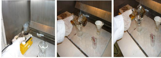
Figura 5: Toma de muestras de aceite usado en volumen de 25 mL con calentamiento a 270 C adicionándole 50 mL de H<sub>2</sub>SO<sub>4</sub> concentrado al 99.8 %
