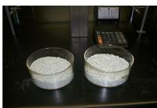
Figura 2: Preparación de Zeolita ZN M-17 (Clinoptilolita) de granulometría menor a 0.9 mm. sin tratamiento térmico.
