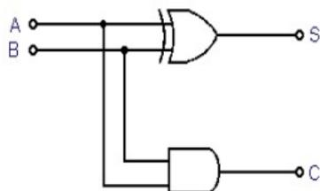
Fig. 3. - Circuit effectuant la somme de 2 bits A et B.
